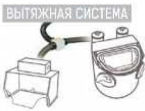
Подключение двух устройств к одной вытяжке
