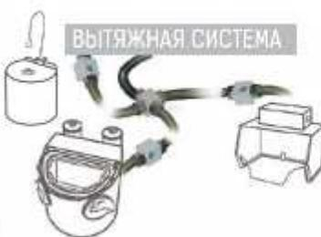
Работа с тремя устройствами через разветвитель. Позволяет отключать те устройства, которые в данный момент не используются.
